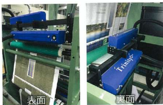
写真 1 センサーシステムの搭載例
