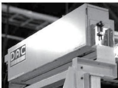
段ボール印刷検査装置カメラボックス
